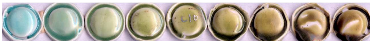
Photo 5 : Le titane dans le céladon CG
