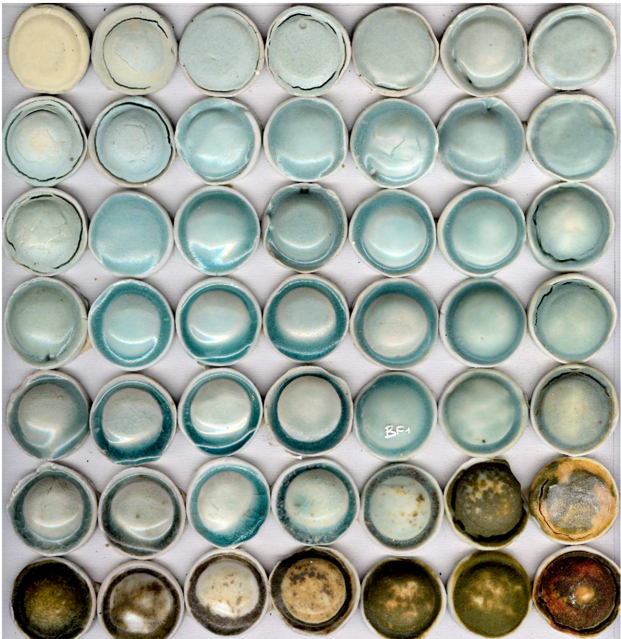
Cuisson à 1300°C selon la courbe de cuisson des bleus de fer et rouges de cuivre
