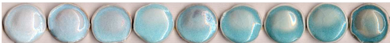
Photo 8 : Augmentation progressive de l'ocre dans un bleu
