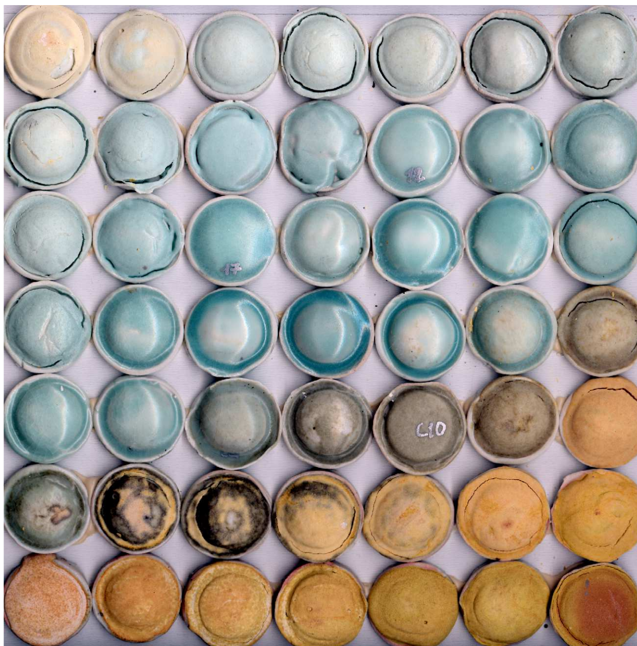
Photo 3 : Les essais "en carré" autour de l'eutectique calcique
