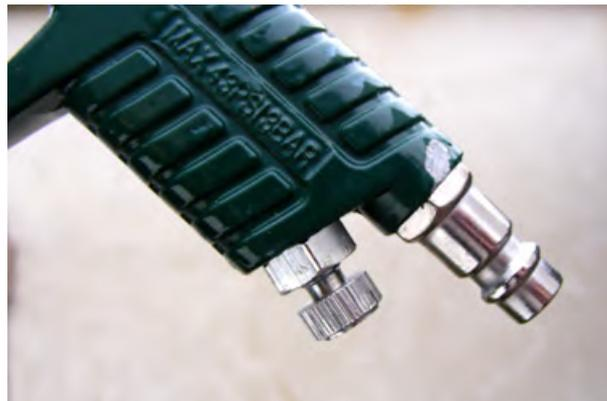
Avec la molette ci-dessus ou celle du compresseur, régler la pression de telle manière que le nuage d'engobe ne contienne pas de grosses gouttes. On doit obtenir une surface plate, lisse, sans pointillés.
