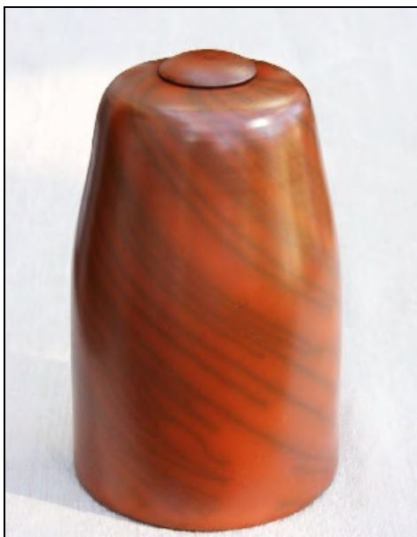
Engobe de sigillée sur faïence blanche cuisson oxydante à 1030° + enfumage à 500°C
